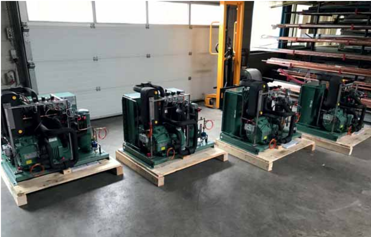
Vier chillers, klaar voor transport naar CERN. Foto: Wagenaar Koeltechniek.
